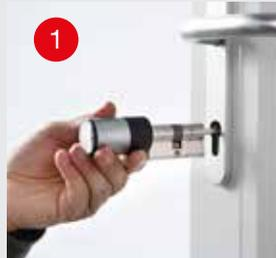
1 Vorhandenen Profil-Zylinder entfernen und den elektronischen TSE-Profil-Zylinder von der Innenseite einsetzen.
